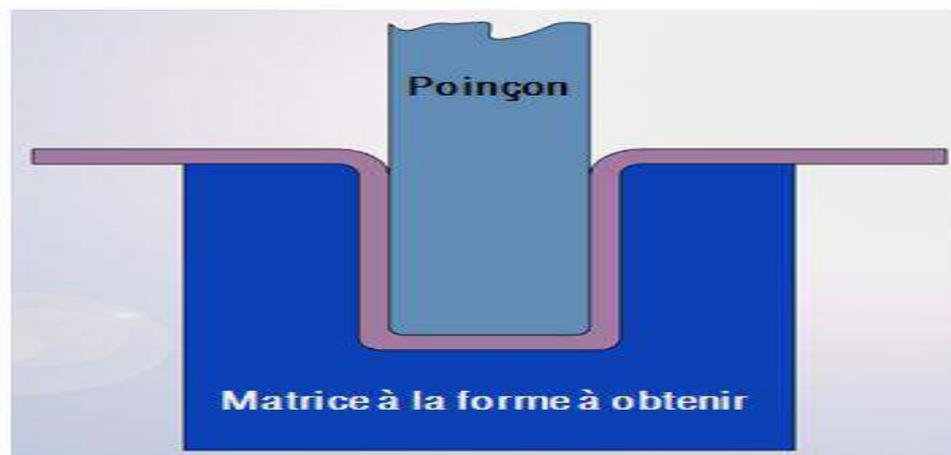
**Figure I.17:**Pliage par cambrage en U.
