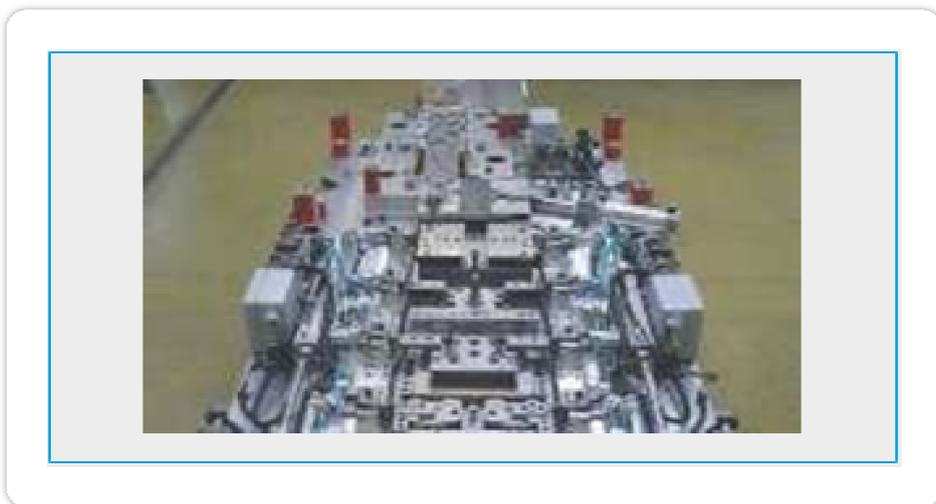
**Figure II.14:** Outil avec système transfert intégré.
