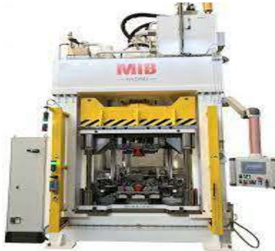
Figure II.10 : Presse mécanique à triple effet.
