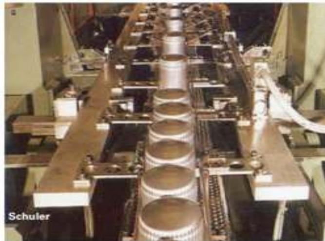
**Figure II.18:** Outil avec système transfert sur presse.
