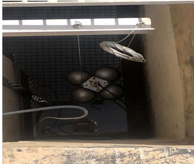
**Figure I-7** : électrodes flottantes
