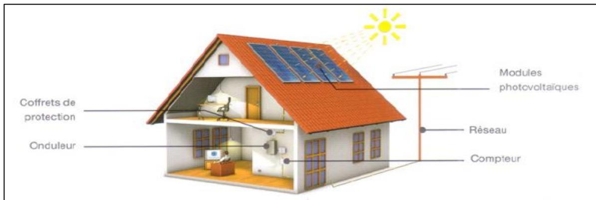
**Fig I.16 Schéma de principe d'une installation PV raccordée au réseau**
