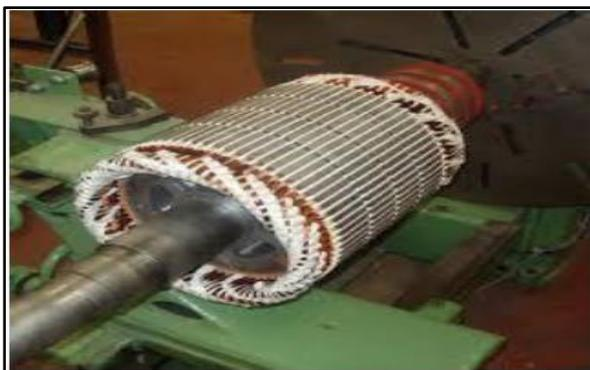
Figure I.4: Rotor bobiné d'une MAS.
