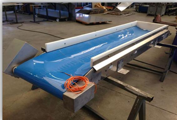
Figure II. 111 : Convoyeur à auge
