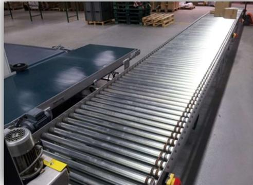
**Figure II. 22 :** Convoyeur à rouleaux
