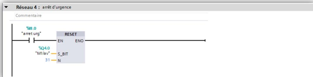
Figure III. 17 : Réseau d'arrêt d'urgence
