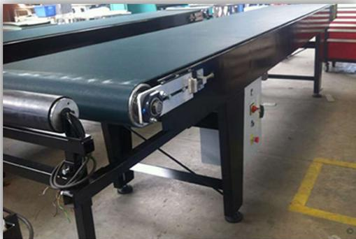
Figure II. 19 : Convoyeur textile
