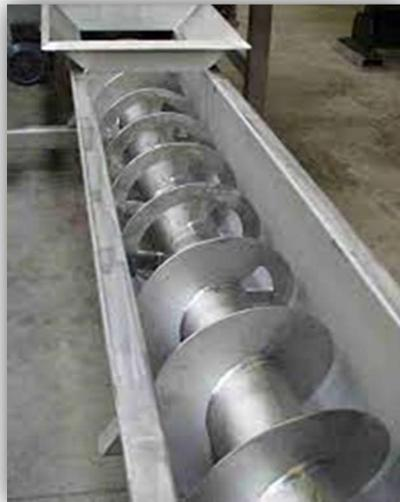
**Figure II. 25 :** Convoyeur à vis sans fin
