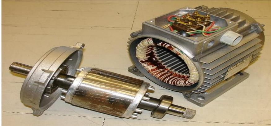
Figure I- 8: Rotor (à gauche) et stator (à droite) d'une Machine asynchrone 0,75 kW [14]
