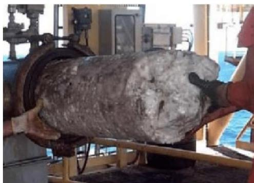
Figure I. 3:tuyau bouché avec sels
