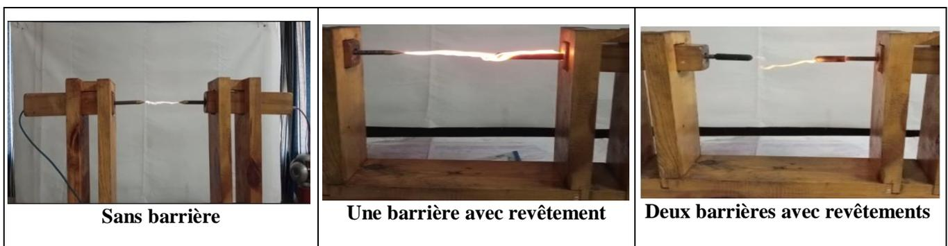
**Figure III. 14 :** Trajet de la décharge électrique disruptive de système pointe – pointe sans barrière et avec barrière avec revêtement superhydrophobe
