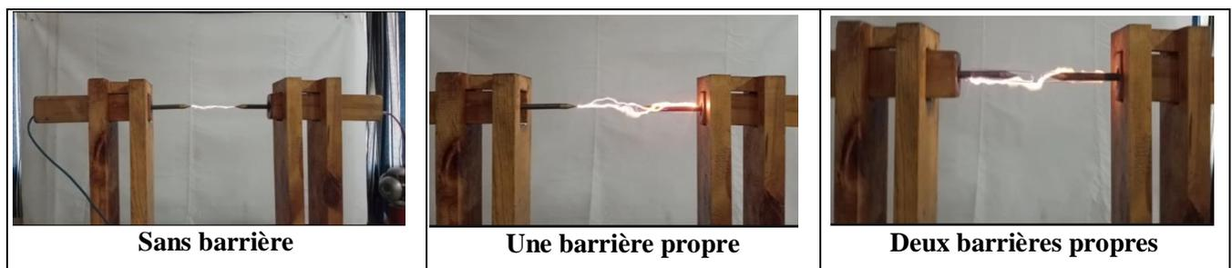
**Figure III. 8 :** Trajet de la décharge électrique disruptive de système pointe – pointe sans et avec barrière propre
