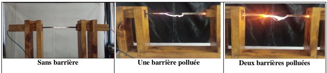
**Figure III. 11 :** Trajet de la décharge électrique disruptive d'un système pointe – pointe sans et avec barrière polluée
