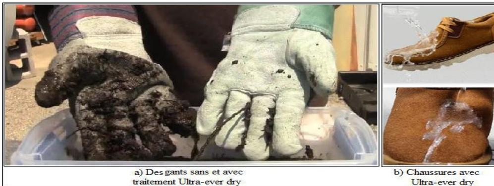
Figure I- 17: Traitement Ultra-Ever dry sur des gants et des chaussures [30]
