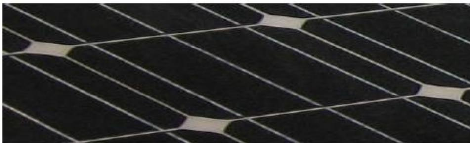
Figure I.4 : Cellules mono cristallines. [9]
