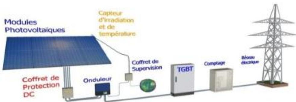
Figure I.9 : Structure d'un système Photovoltaïque connecté au réseau. [14]
