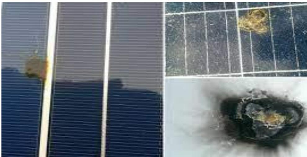
**Figure 3 . 2** : Exemples des points-chaud d'une cellule photovoltaïque.
