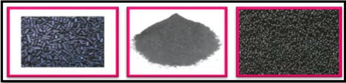
**Figure I.2** : Formes du charbon actif de gauche à droite : extrudé, en poudre et en grain
