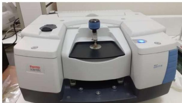
**Figure II.10 :** Appareil de l'infrarouge à transformée de Fourier (IRTF).
