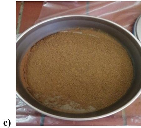
**Figure II.2 :** a) Broyeur à épices, b) Tamis 100 mm, c) Particules de grignons d'olive de granulométrie supérieure à 100 micromètre.
