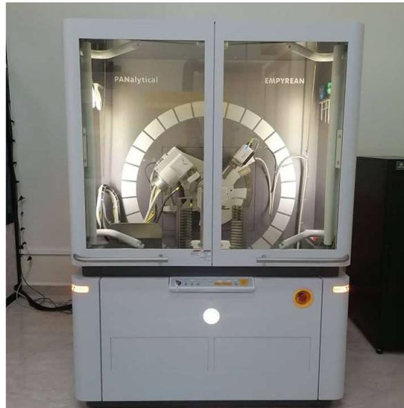
**Figure II.12 :** Illustration d’un diffractomètre de type Empyrean.
