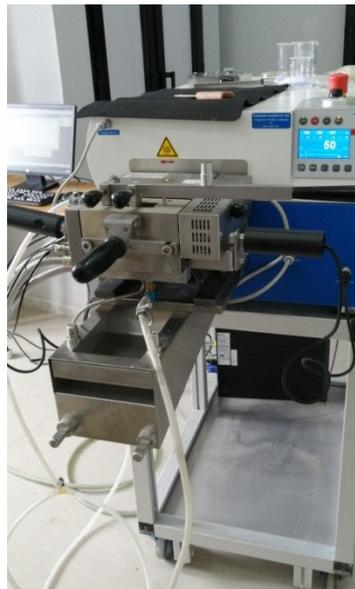
**Figure II.8** : Plastographe brabender 30EHT
