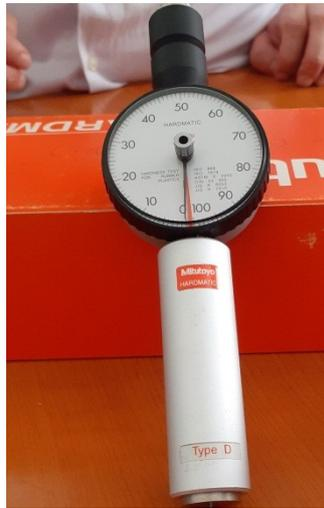
**Figure .II.16 :** Appareil de dureté (Shore D) MITOTOYO HARDMATIC
