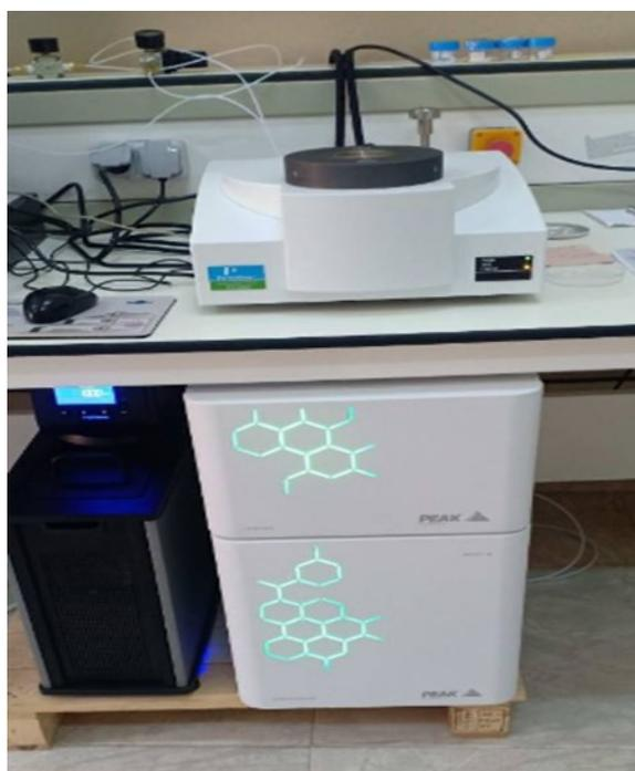
Figure II.14 : Appareil de l'analyse thermogravimétrique (ATG) de marque Perkin Elmer, Waltham.
