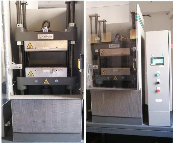
Figure II.9 : Presse hydraulique à plateaux chauffants de marque CARVER press.
