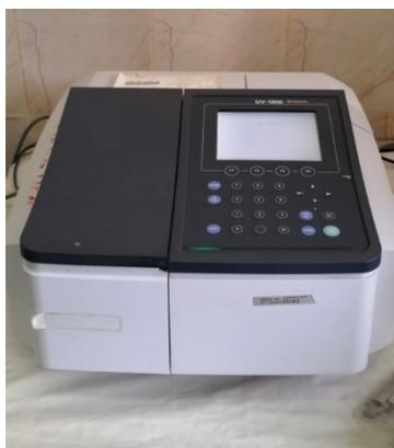
**Figure II.11 :** Appareil de spectrophotométrie UV-visible (UV 1800).
