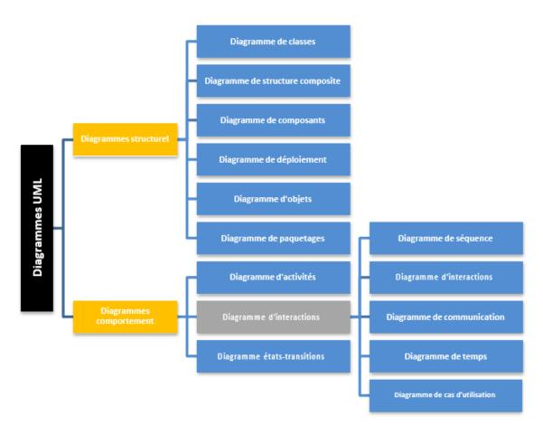
Figure II.4 : les différents types de diagrammes UML
