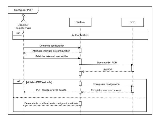
Figure 2.5 – Diagramme sequence « Configurer PDP ».
