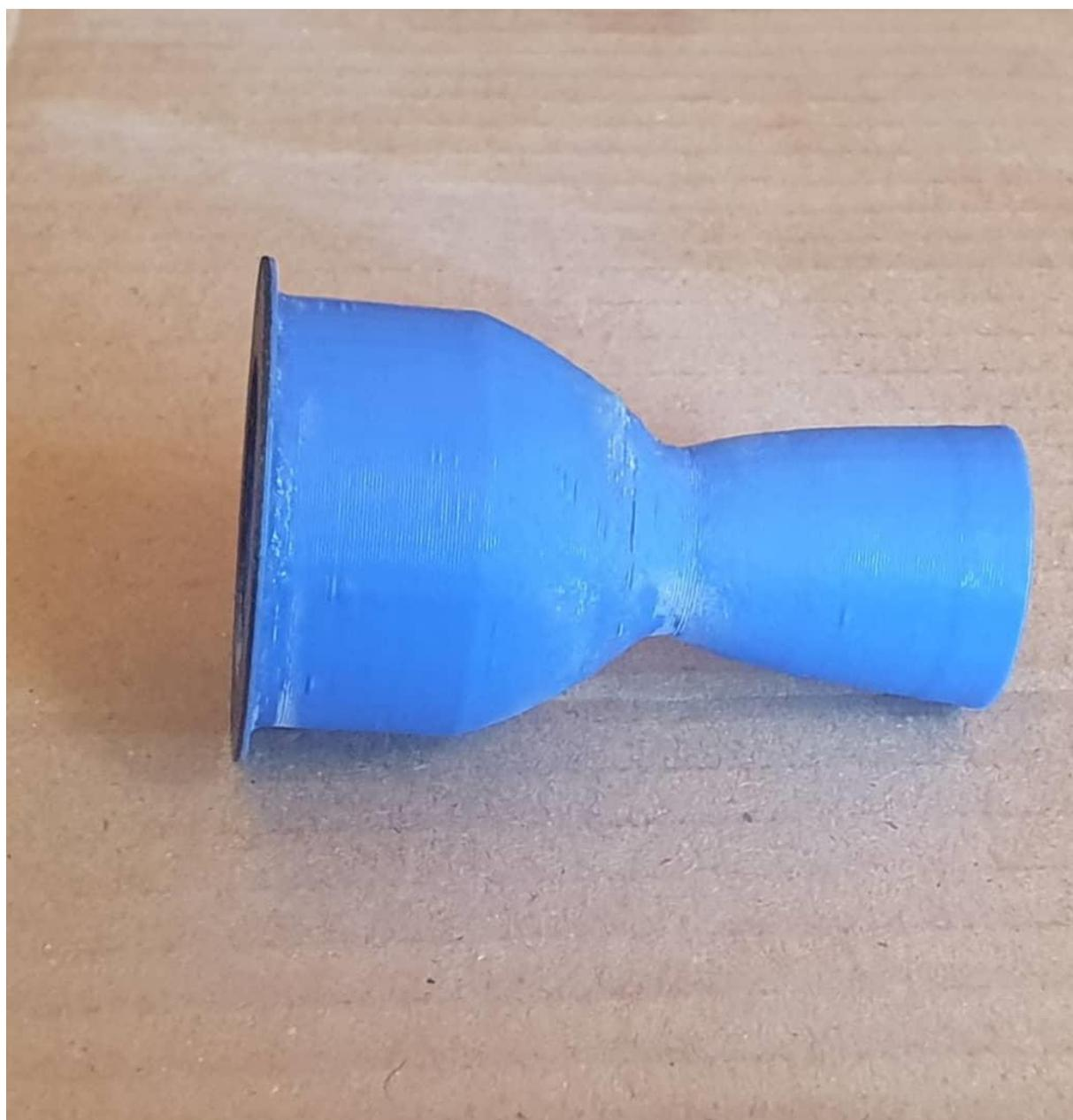
**Figure III-14 :** La tuyère réalisée par l'imprimante 3D.
