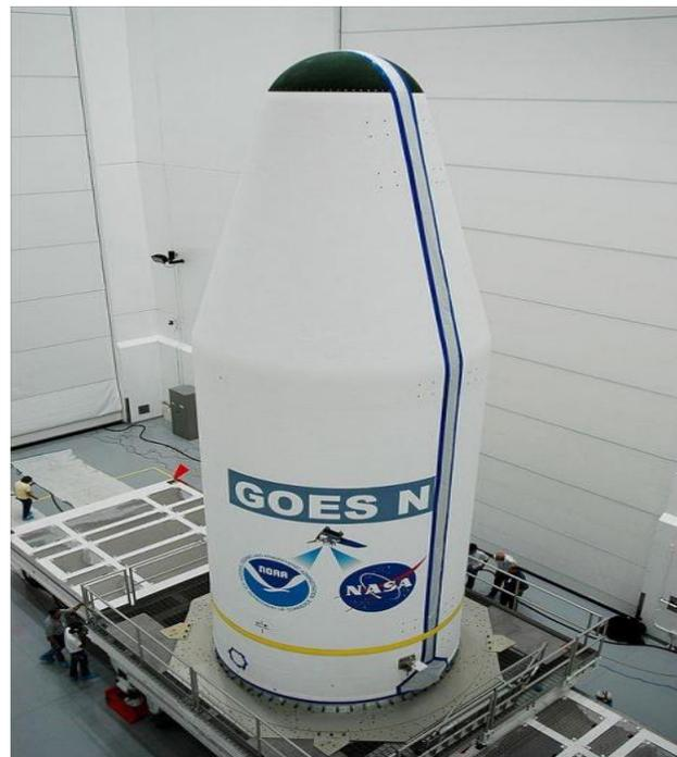
Figure I-3 : la coiffe du lanceur Boeing Delta IV.
