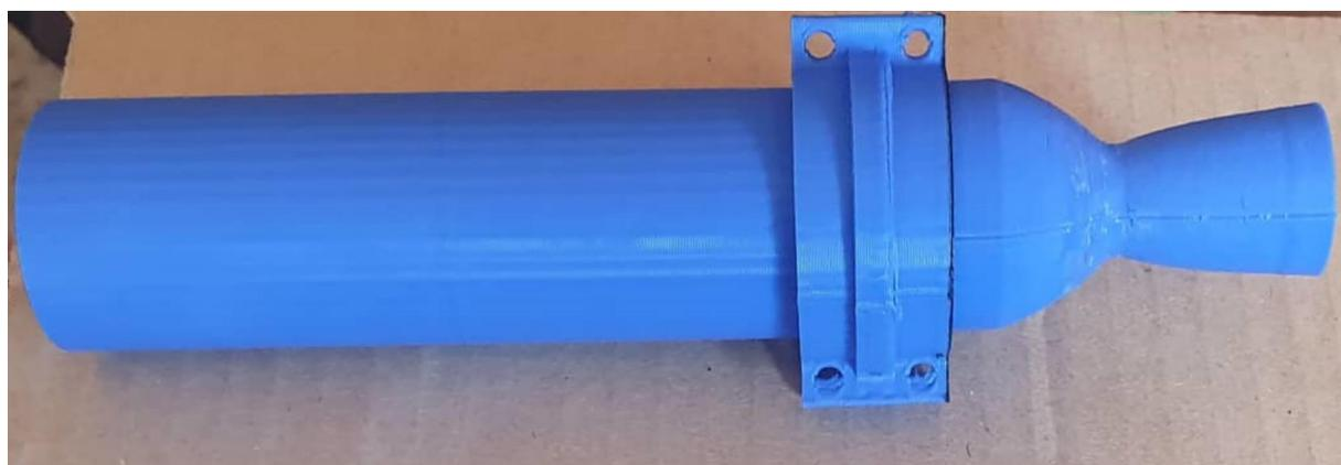
**Figure III-16 :** L'assemblage de la chambre de combustion et de la tuyère.
