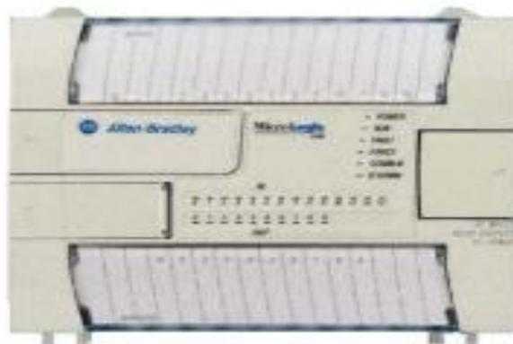
Figure II-3 : Automate programmable de type compact [8]
