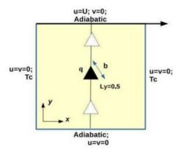
**Figure I.12:**représentation schématique du domaine de calcule ainsi que des conditions aux limites [11].
