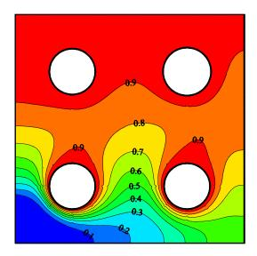
Figure III.17 :L'influence de nombre de cylindre sur les isothermes avec  $Ri=10et\Omega=0.1$ .
