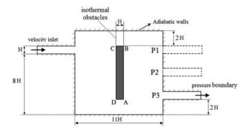
Figure I.11: géométrie du problème pour la cavité ventile [10].
