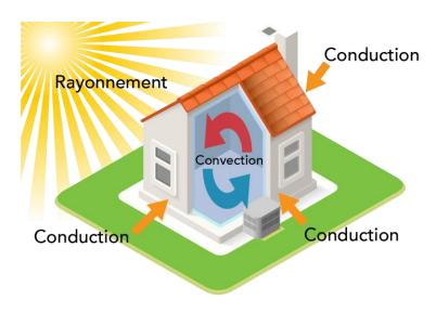
Figure I.1 : schéma de différents types de transfert de chaleur.
