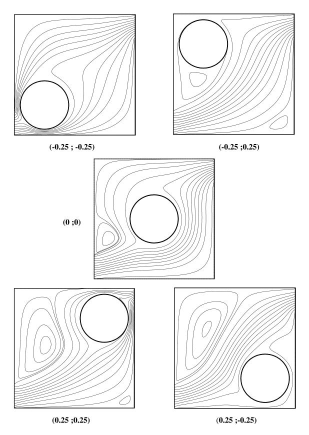
$\textbf{Figure III.10 :} L'influence \ de \ la \ position \ de \ cylindre \ sur \ les \ fonctions \ de \ courants \ avec$
