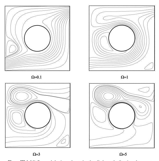
**Figure III.4:** L'influence de la vitesse de rotation de cylindre sur les fonctions de courant pour Ri=1.
