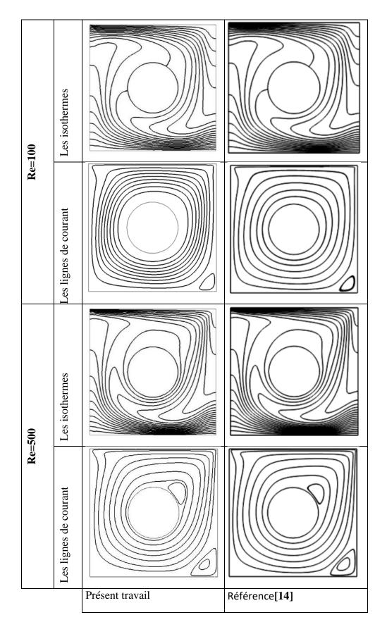
Figure III.2: comparaison des lignes de la fonction de courants et les isothermes.
