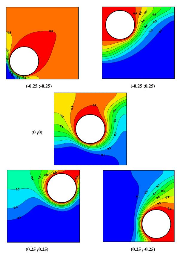
Figure III.11:L'influence de la position de cylindre sur les isothermes avec Ri=1;  $\Omega=0.1$ .
