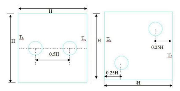
**Figure I.16 :** Configuration schématique du modèle considère avec coordonnées et conditions aux limites [15].
