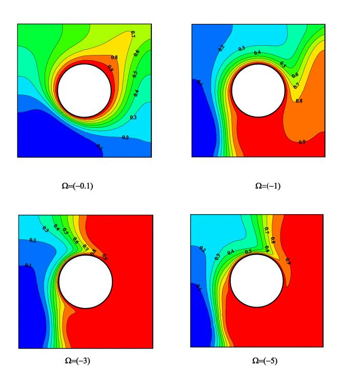
**Figure III.8** :L'influence de la vitesse de rotation de cylindre sur les isothermes pour Ri=1
