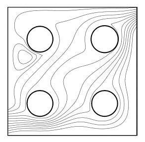
Figure III.16 :L'influence de nombre de cylindre sur les fonctions de courants avec  $Ri=10et\Omega=0.1$ .
