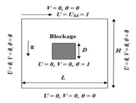
Figure I.9: Géométrie d'une cavité munie d'un bloc isotherme posé au milieu [8].
