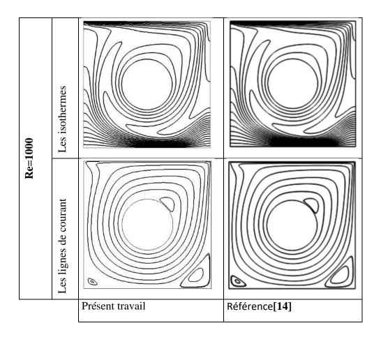
Figure III.3: comparaison des lignes de la fonction de courants et les isothermes.
