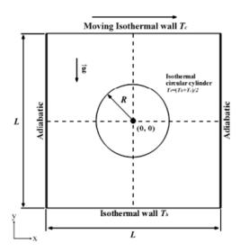
Figure I.15:Schéma approprié [14].
