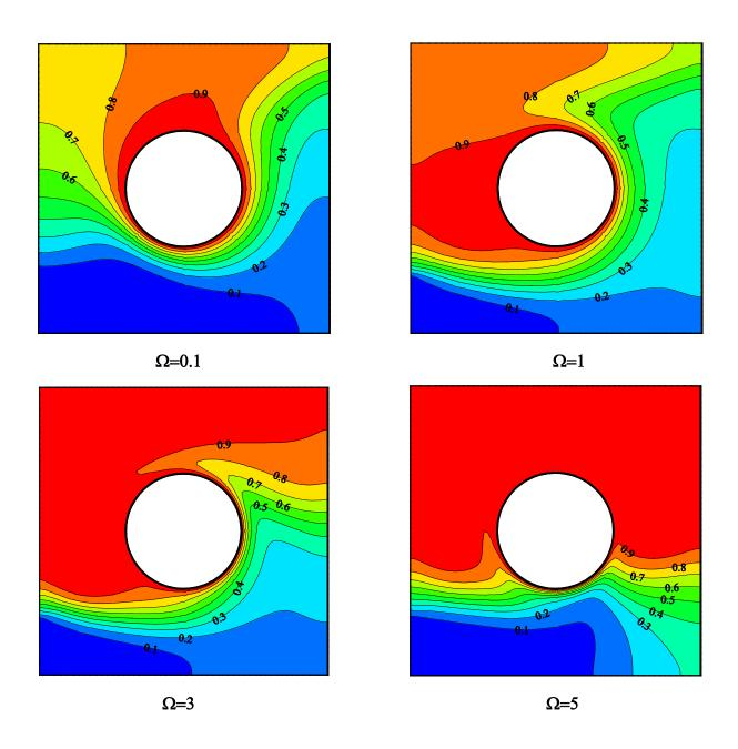
**Figure III.5:** L'influence de la vitesse de rotation de cylindre sur les isothermes pour Ri=1.
