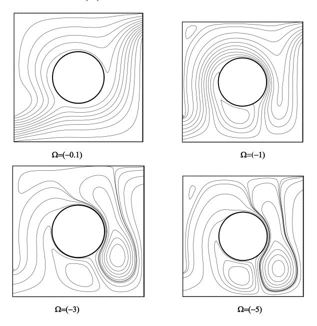
**Figure III.7 :**L'influence de la vitesse de rotation de cylindre sur les fonctions de courant pour Ri=1
