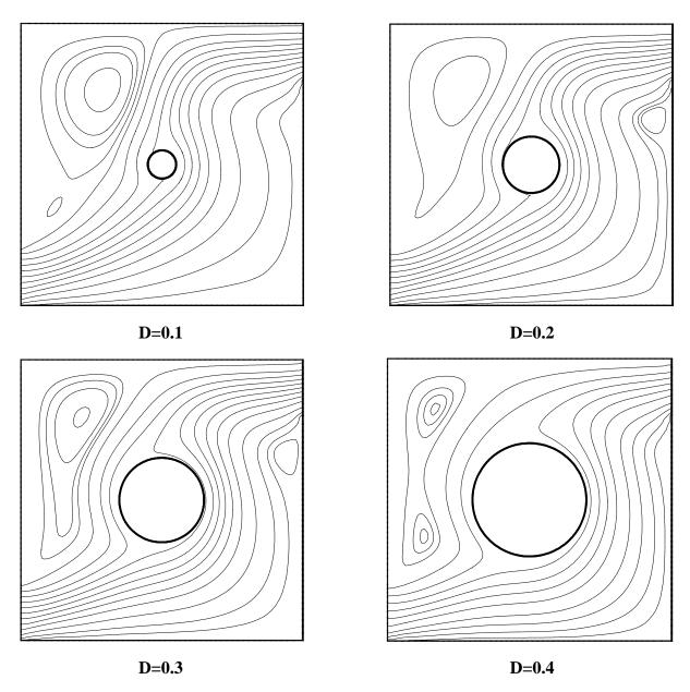
Figure III.13 :L'influence de la position de cylindre sur les fonctions de courants pour Ri=10;  $\Omega=0.1$ .
