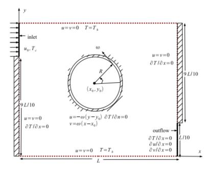
Figure I.19 : Géométrie et conditions aux limites de la cavité [18].
