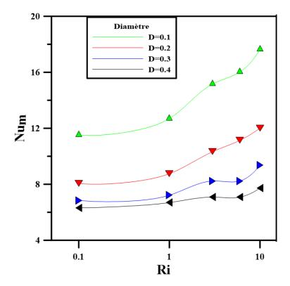
**Figure III.15**:Influence de nombre de Nusselt moyen en fonction de nombre de Richardson pour les différents diamètres de cylindre.
