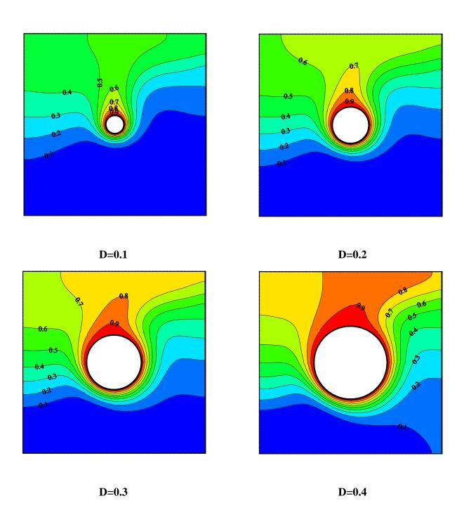
Figure III.14:L'influence de diamètre de cylindre sur les isothermes Ri=10;  $\Omega=0.1$ .
