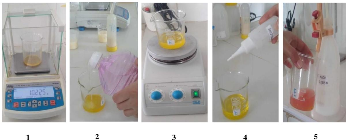
**Figure 6:** Les étapes de détermination de l'acidité: 1) Pesée 10g d'huile, 2) Ajoutée 75ml d'alcool neutralisé, 3) Chauffée le mélange, 4) Ajoutée quelque goutte de Phénolphthaléine, 5) titrée avec de la soude.
