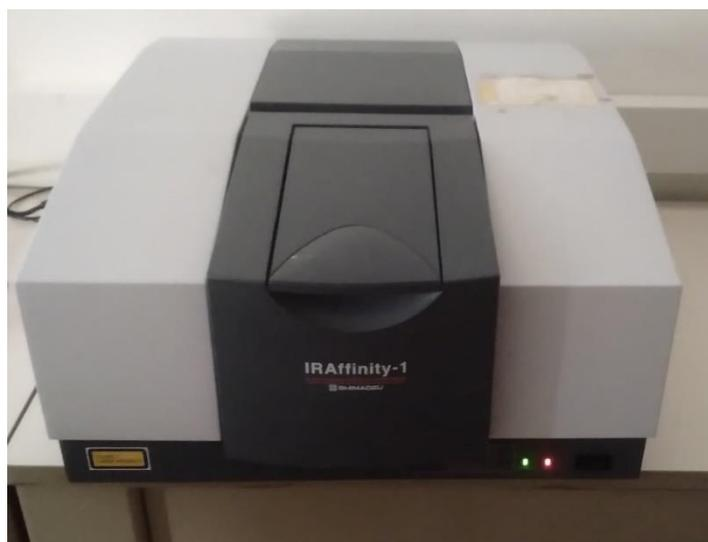
**Figure 10:** Spectromètre infrarouge
