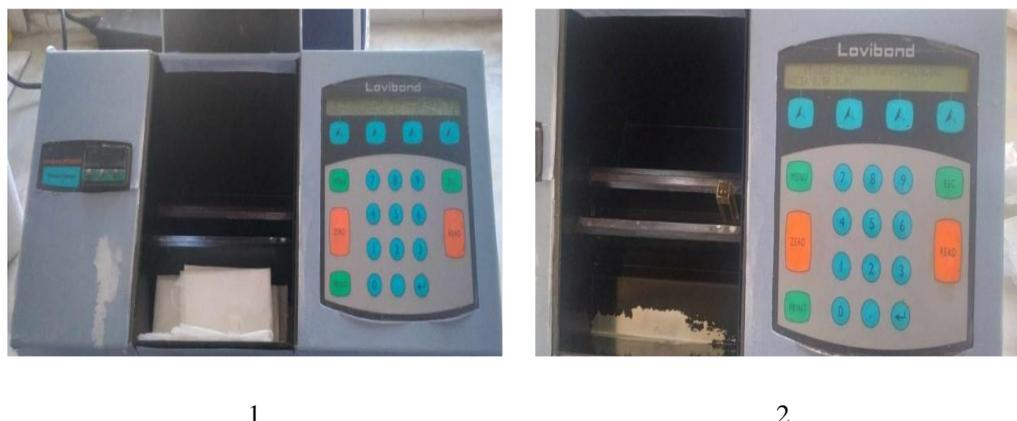
**Figure 8:** Calorimètre « LOVIBOND »
