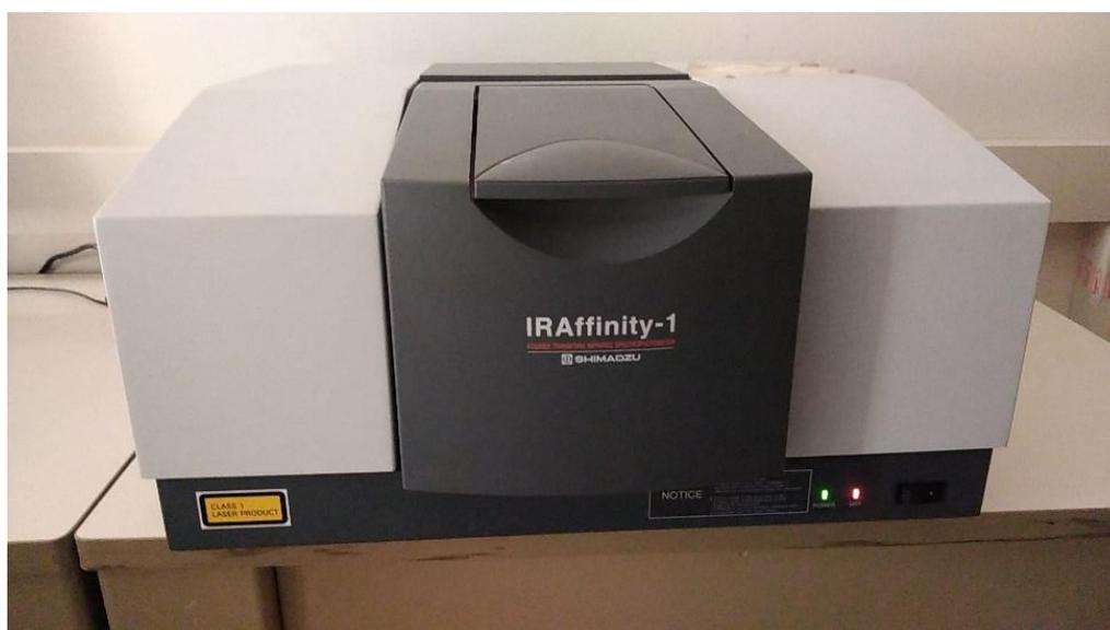
**Figure II.6.** Shimadzu IRAffinity-1 FTIR Spectrophotometer.
