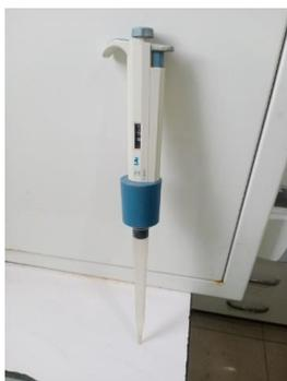
*Figure III.6 : micro-pipette*
