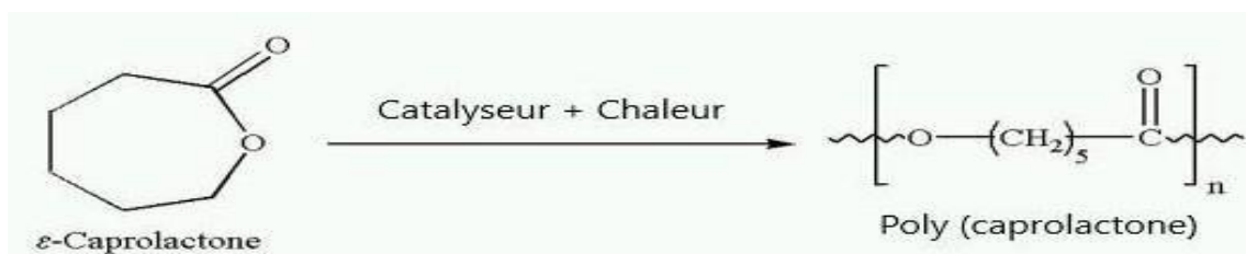
Figure I.5: Synthèse du PCL en présence d'un catalyseur [14]
