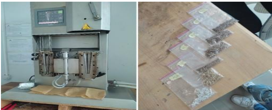
Figure IV.4: Obtention des granulées de biocomposites après extrusion
