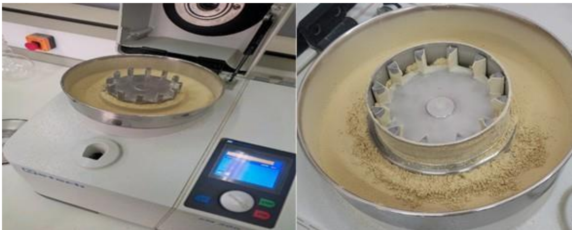
Figure IV.1: Broyage mécanique de la fibre
