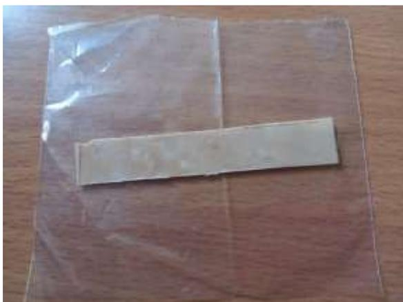
**PHBV/PP/TiO<sub>2</sub> avant la biodégradation**
