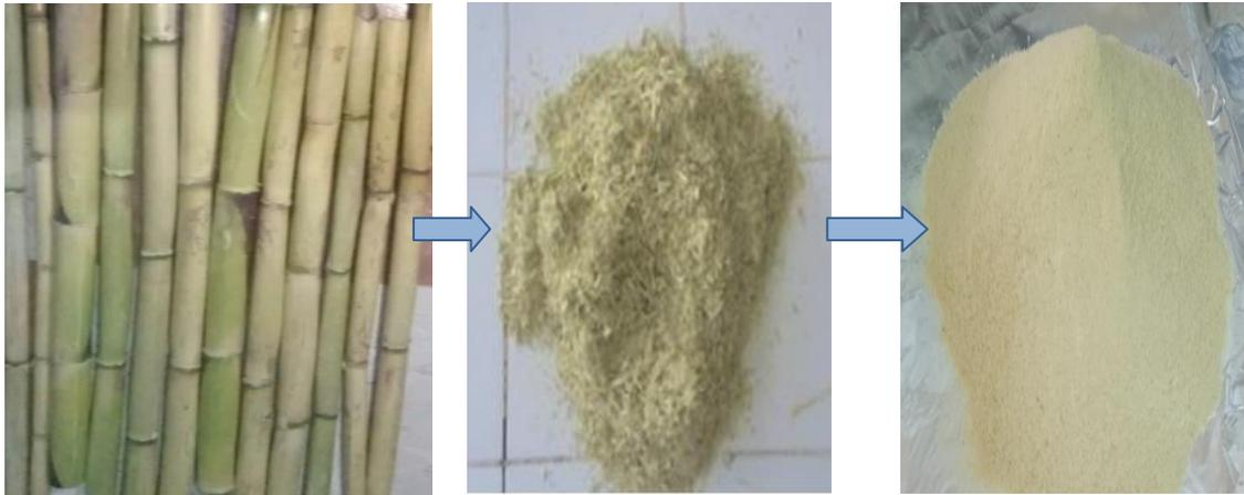
Figure II.4: Illustration des étapes d'obtention de la farine d'AD.
