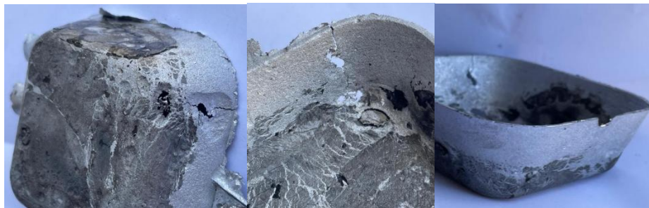
Figure III. 6:Fissure et retassure de la pièce
