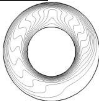
Figure III-2: Comparaison avec Al-Amiri et al [29], Cylindre extérieur tournant, N=1 , Re = 100 et Gr = 10^4 , (a) Nombre de Nusselt et Sherwood moyen, (b) Isoconcentration, lignes de courants et isothermes, for Le=1 .
