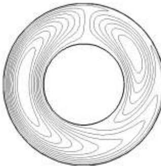
Figure III-2: Comparaison avec Al-Amiri et al [29], Cylindre extérieur tournant, N=1 , Re = 100 et Gr = 10^4 , (a) Nombre de Nusselt et Sherwood moyen, (b) Isoconcentration, lignes de courants et isothermes, for Le=1 .
