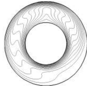
Figure III-2: Comparaison avec Al-Amiri et al [29], Cylindre extérieur tournant, N=1 , Re = 100 et Gr = 10^4 , (a) Nombre de Nusselt et Sherwood moyen, (b) Isoconcentration, lignes de courants et isothermes, for Le=1 .
