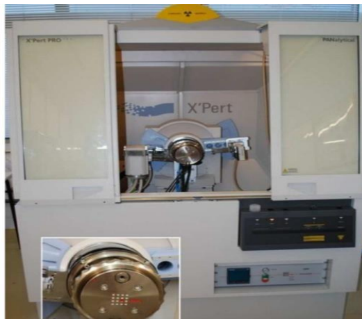
Figure II.7: Dispositif Diffraction X : X'PERT PRO MRD de chez PANalytical.
