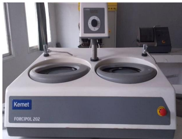
Figure II.5 : polisseuse mécanique à papier abrasif.
