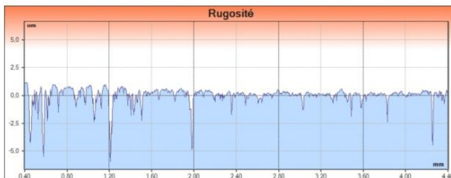
Figure III.8 : Profil de rugosité de dépôt \text{Cr}_2\text{O}_3 sans traitement thermique.
