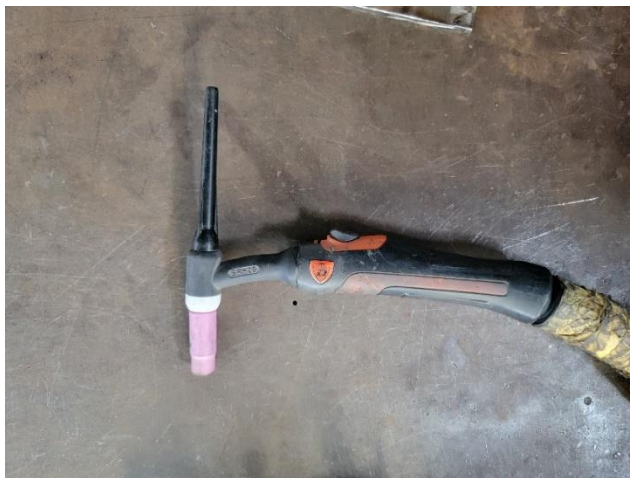
Figure IV.8 : torche de soudage TIG
