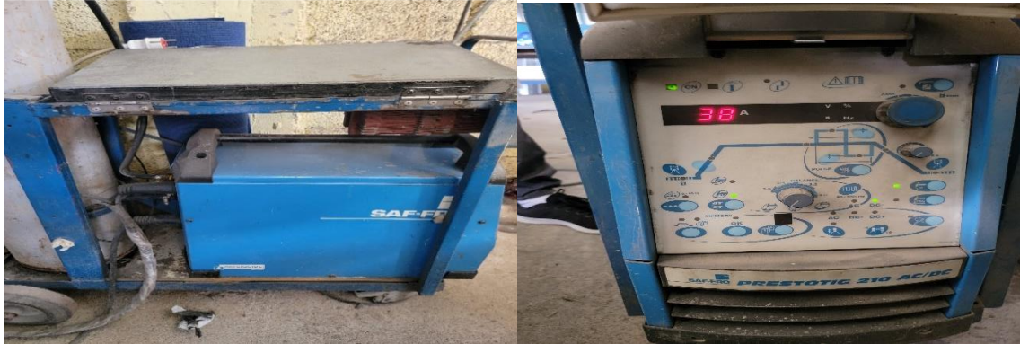
Figure IV.7 : poste a souder TIG SAF-FRO
