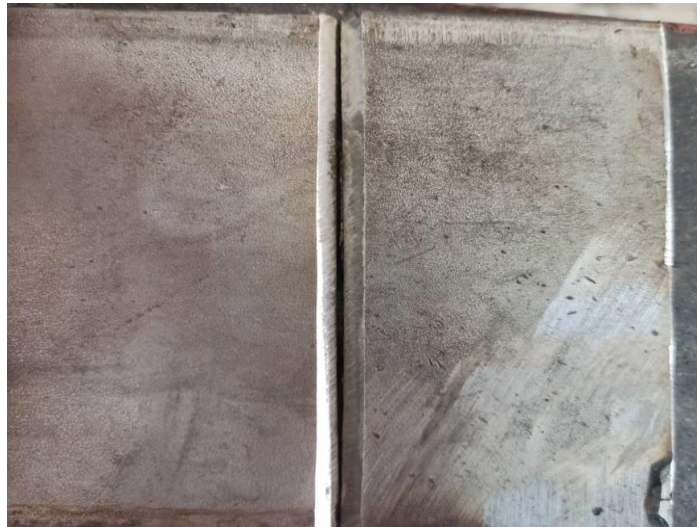
Figure IV.5 : les deux pièces à assembler chanfreinées.
