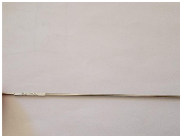
Figure IV.10. : Baguette d'apport TIG1
