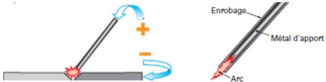
Figure II.5 : soudage a l'électrode enrobée [8]
