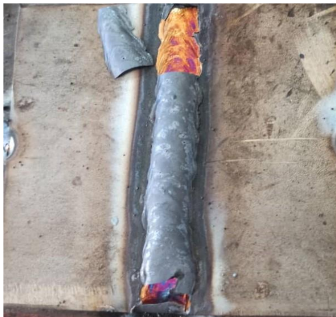
Figure IV.6 : retrait du laitier du procès MMA
