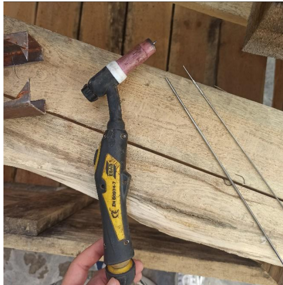
Figure IV.13 : torche de soudage ESAB
