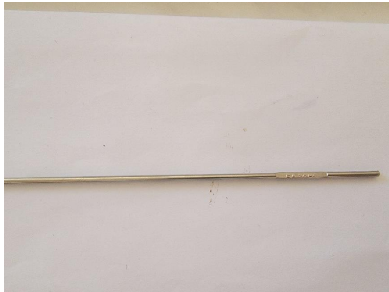
Figure IV.15 : baguette d'apport TIG 2
