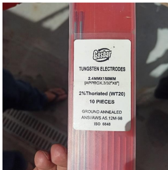
Figure IV.14 : électrode tungstène 2% thorié
