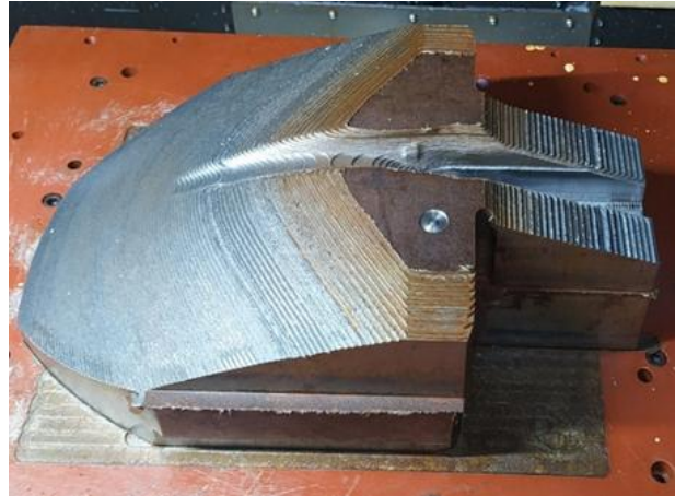
Fig III. 9 L'opération d'ébauche sur RHINOCAM et réel
