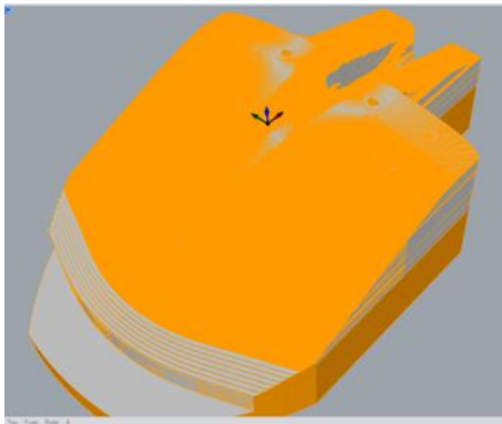
Fig III. 10 L'opération du semi-finition sur RHINOCAM et réel
