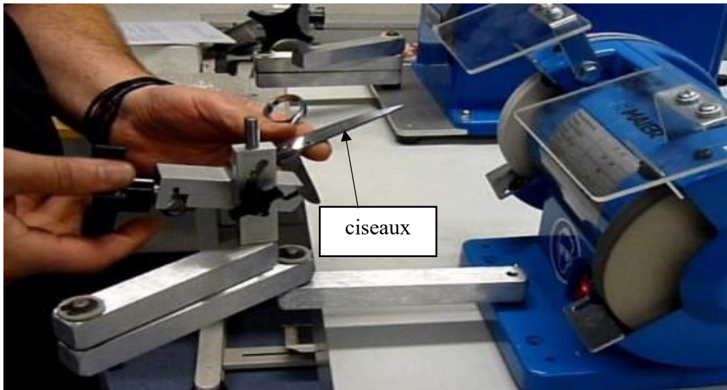
Figure 1.4 : Affûtage des ciseaux [3].
