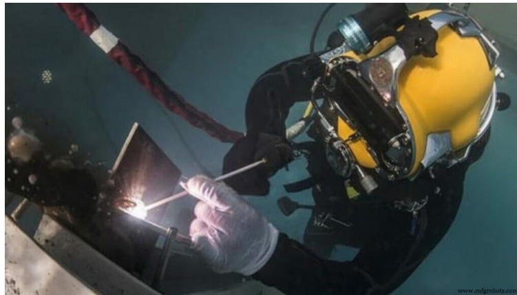
Figure I.12: Soudage à l'arc dans l'atmosphère humide
