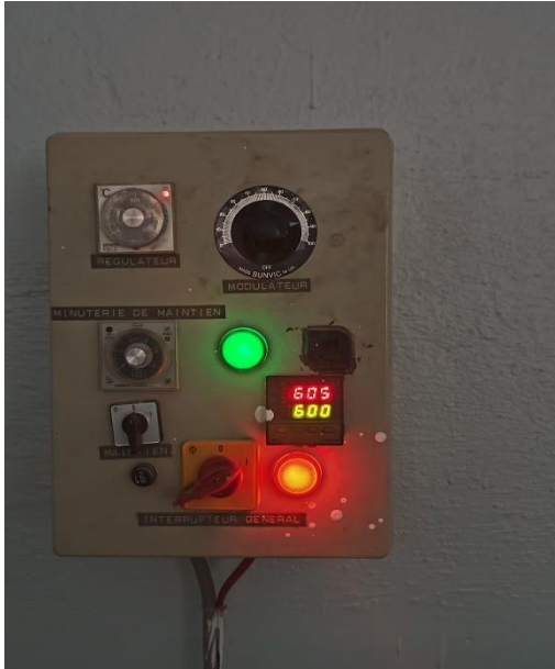
Figure II.4: Température du four réglé à 600°
