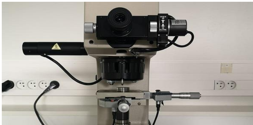
Figure II.10: Testeur de dureté micro-Vickers
