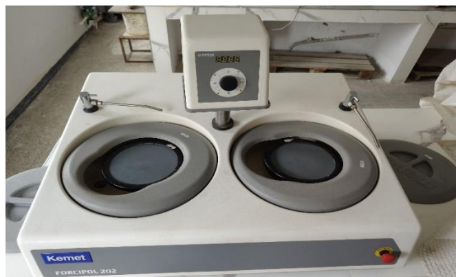
Figure II.6: Polisseuse avec lubrification à l'eau
