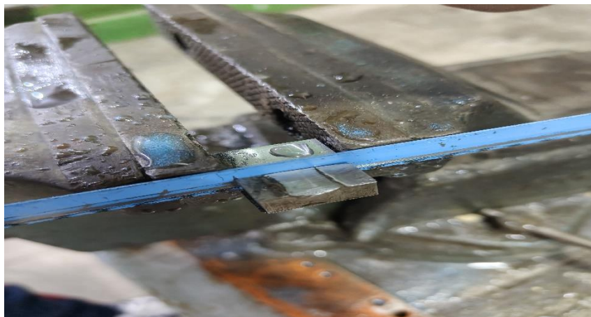
Figure II.2 : Découpage de l'éprouvette à l'aide d'une scie à métaux
