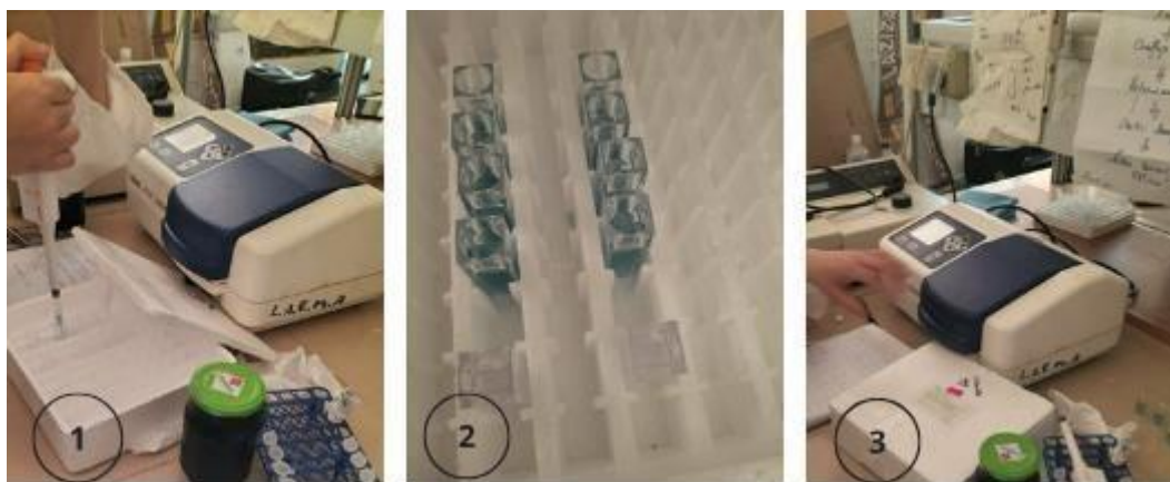
Figure 30 : Mesure de l'activité antioxydante par spectrophotométrie.
