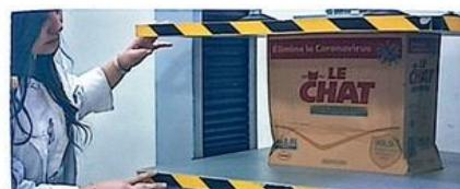
Test RCV de résistance à la compression verticale (Usine d'Akbou)
