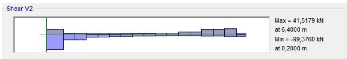
Figure V- 11: Effort tranchant de la poutre maitresse de l'étage courant
