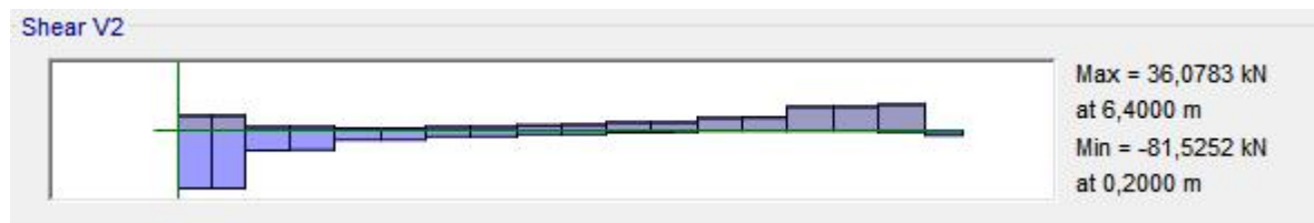
Figure V- 10: Effort tranchant de la poutre maitresse de la terrasse
