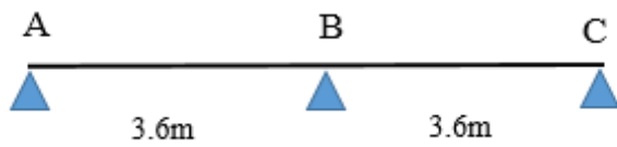
Figure III.9. Schéma statique de type de poutrelle 8 (T. Inaccessible)
