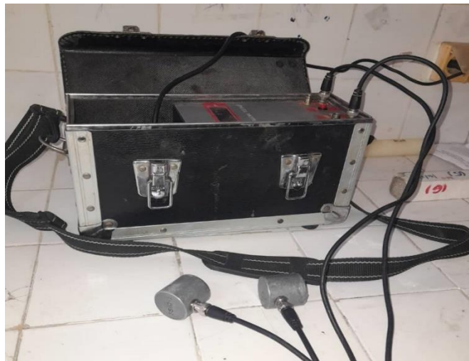
Figure III.20: Dispositif de mesure d'ultrason
