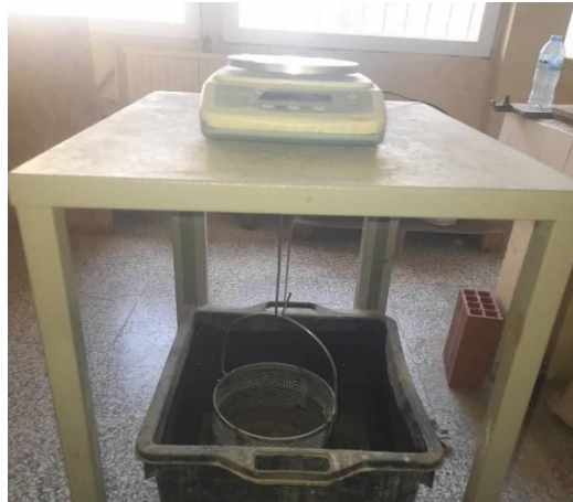
Figure III.9: Dispositif de la pesée hydrostatique
