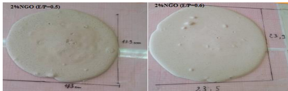
Figure III.2 : Étalement du plâtre à différents rapport E/P (2%NGO)
