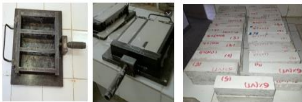
Figure III.8 : Confection des éprouvettes et démoulage
