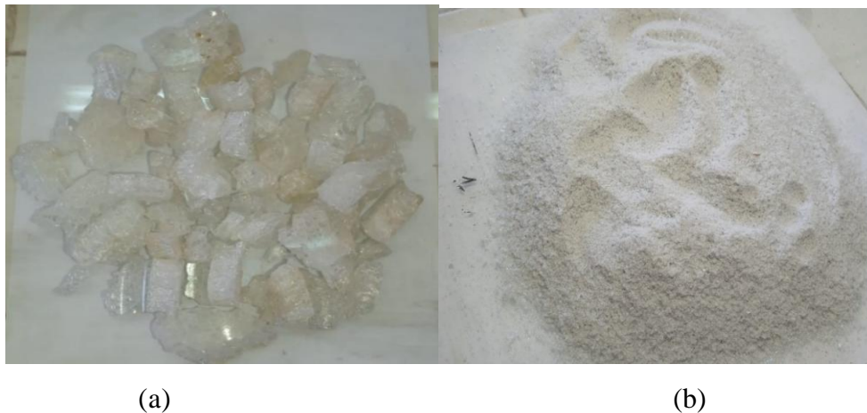
Figure II.4 : ( a) Verre trempé, (b) Verre trempé après broyage
