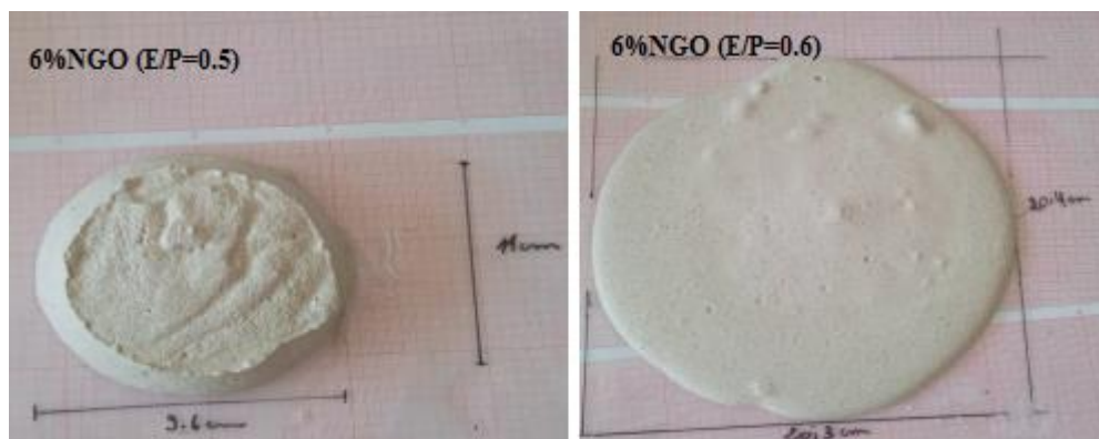
Figure III.4 : Étalement du plâtre à différents rapport E/P (6% NGO)
