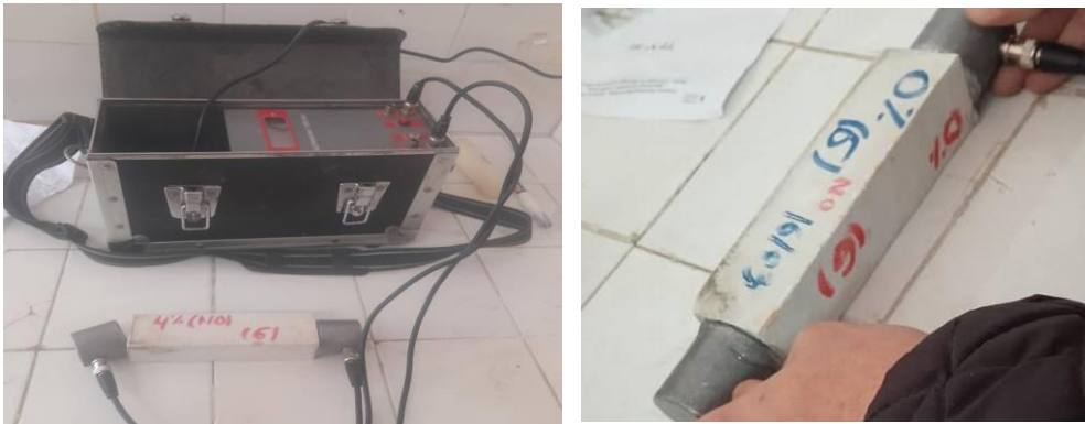
Figure III.21: Essai de mesure d'ultrason sur une éprouvette de plâtre
