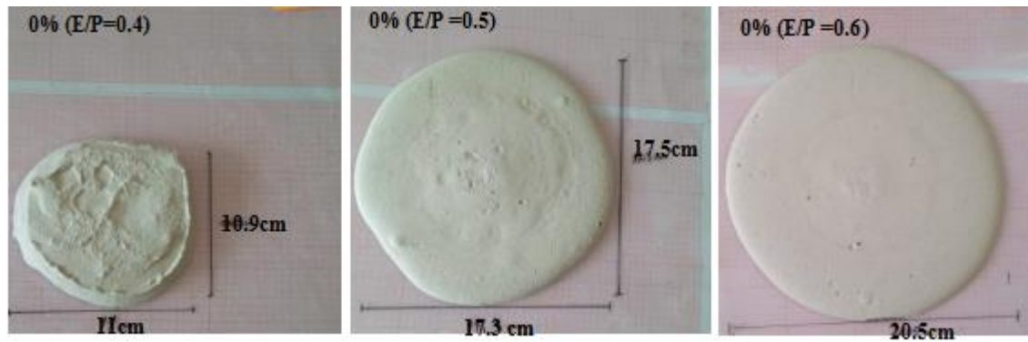
Figure III.1: Étalement du plâtre à différents rapport E/P (0%)
