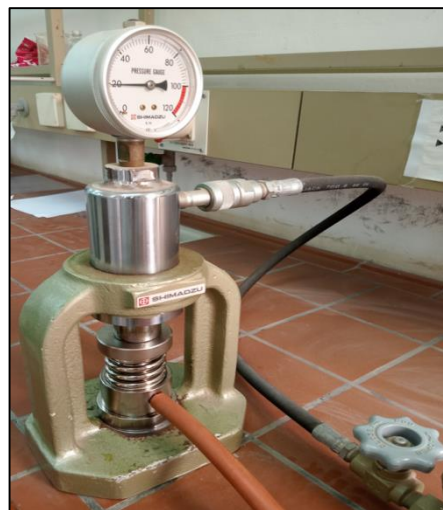
Figure II-18 : Compactage de la pastille
