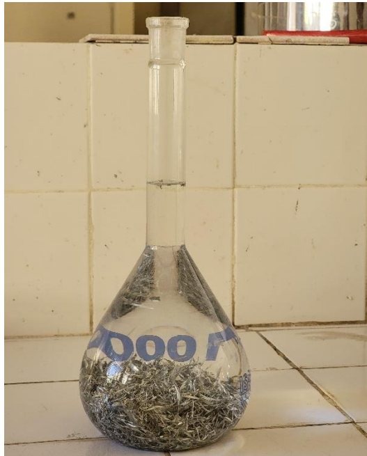
Figure.II.10. La méthode de pycnomètre.
