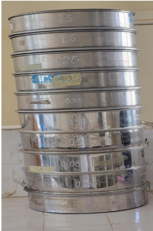
Figure II.6. Sérier des tamis.
