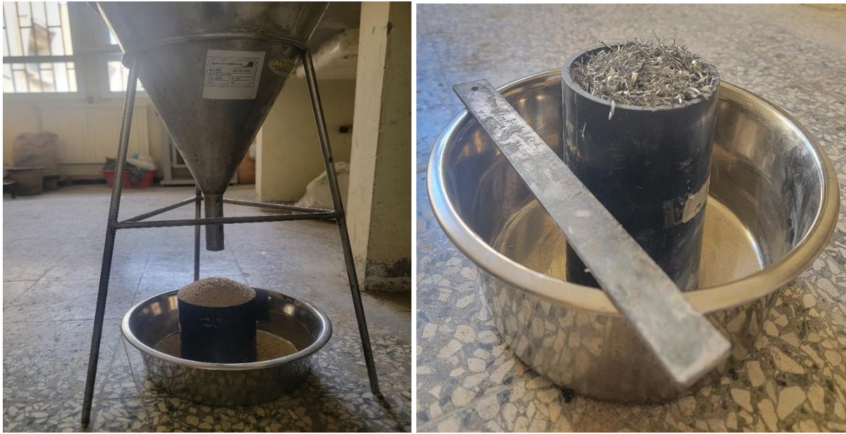
Figure.II.8. L'essai de la masse volumique.
