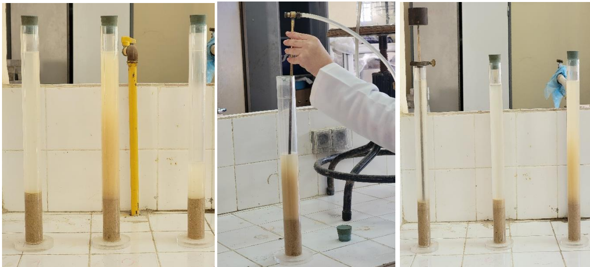
Figure II.7. L'essai d'équivalent de sable.
