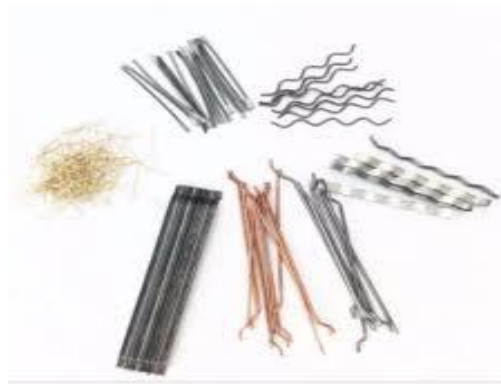
Figure.I.28 : Différentes formes des fibres métalliques.
