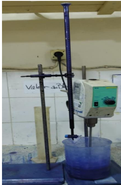
Figure .II . 11. Appareil d'essai de bleu de méthylène
