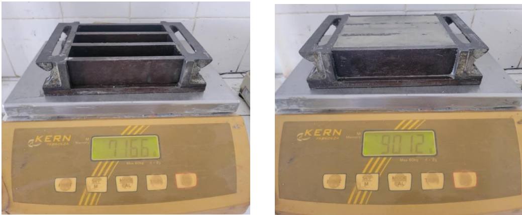
Figure. II.19. Essai de la masse volumique à l'état frais.
