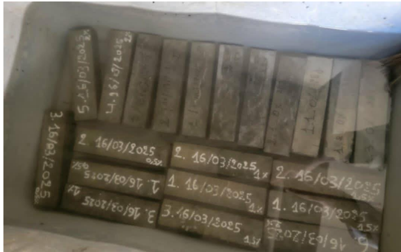
Figure. II.22. Des éprouvettes dans un bac de conservation.
