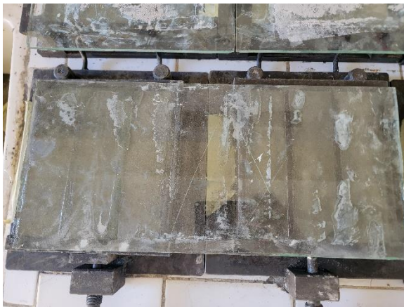
Figure.II.17. Recouvrir les moules.
