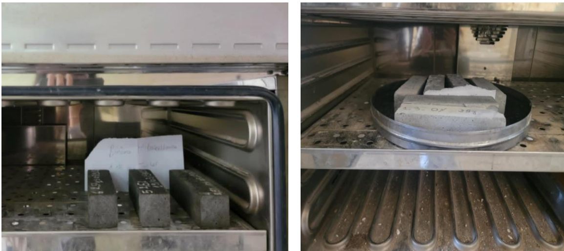
Figure. II.21. Stabilisation du poids par étuvage.
