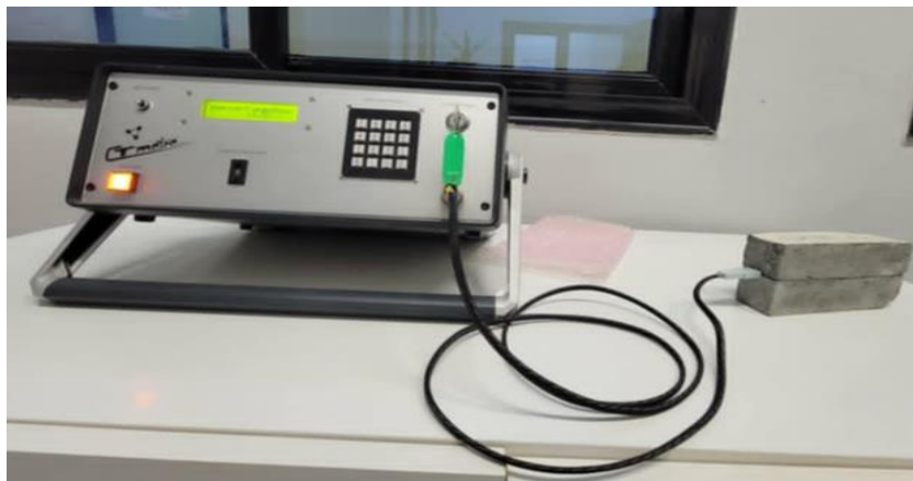
Figure II.27. Dispositif de l'essai de la conductivité thermique
