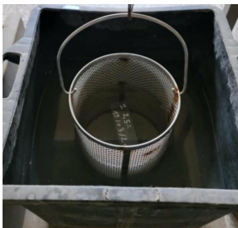
Figure. II.20. La pèse hydrostatique.
