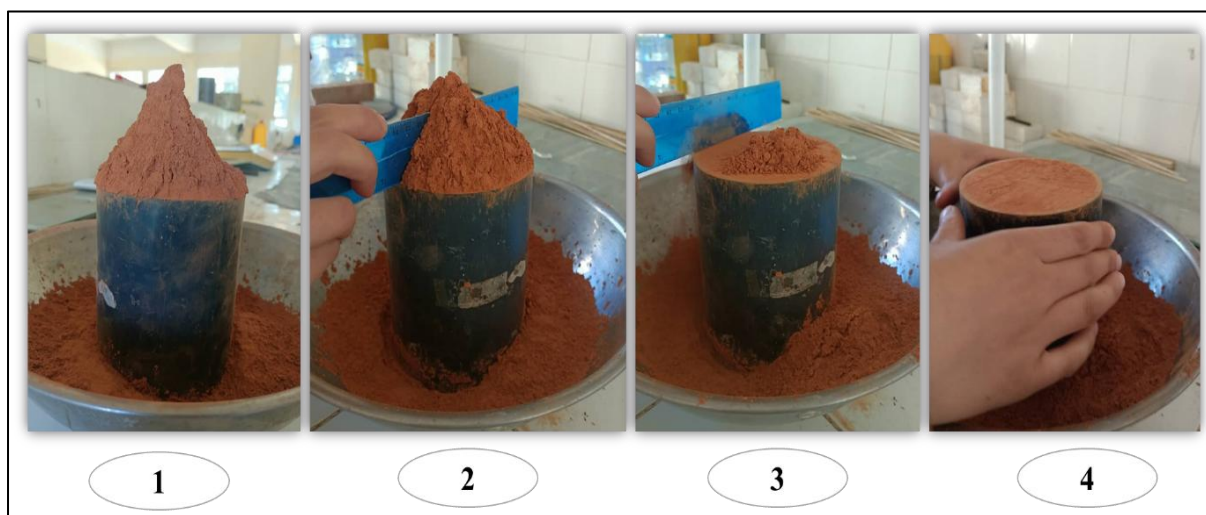
Figure III- 5: Mesure de la masse volumique apparente du déchet de brique.
