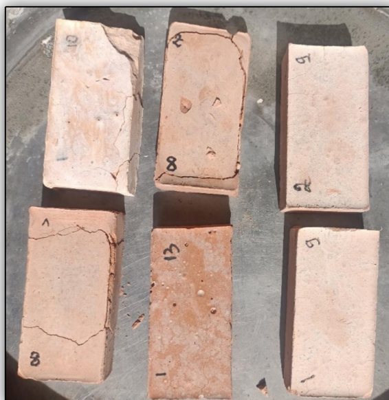
Figure IV-2: Fissures observées à la surface des géopolymères.
