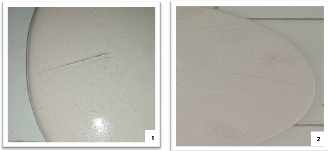
Figure II. 9.1. Mesure du temps de début de prise par la méthode du couteau.
