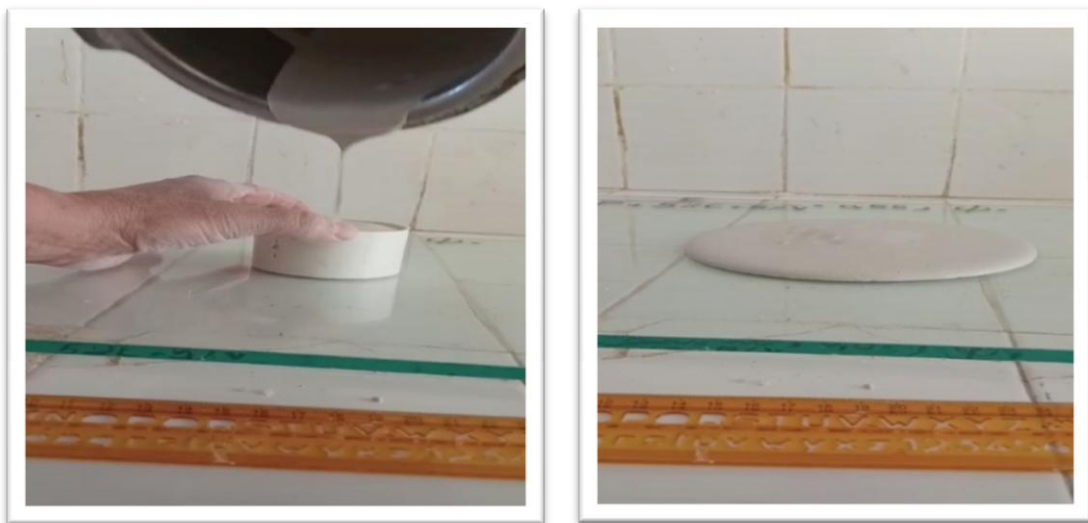
Figure II. 8. Moule en forme de cône en caoutchouc de 40 mm de hauteur et 75 mm de diamètre intérieur et la table d'étalement
