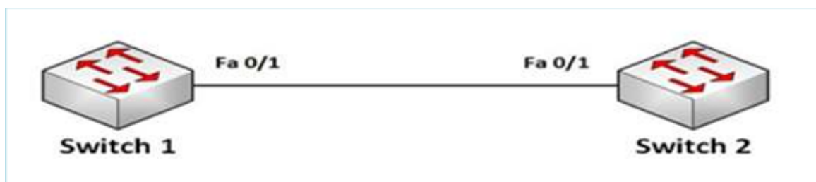
FIGURE II.5 – Schéma illustre l'interconnexion de deux switch sans Etherchannel [38]
