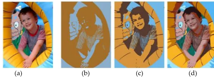
FIGURE III.7 – Segmentation par la méthode des K-means (a) image originale, résultats de la segmentation pour (b) K=2 , (c) K=3 , (d) K=10 [26].
