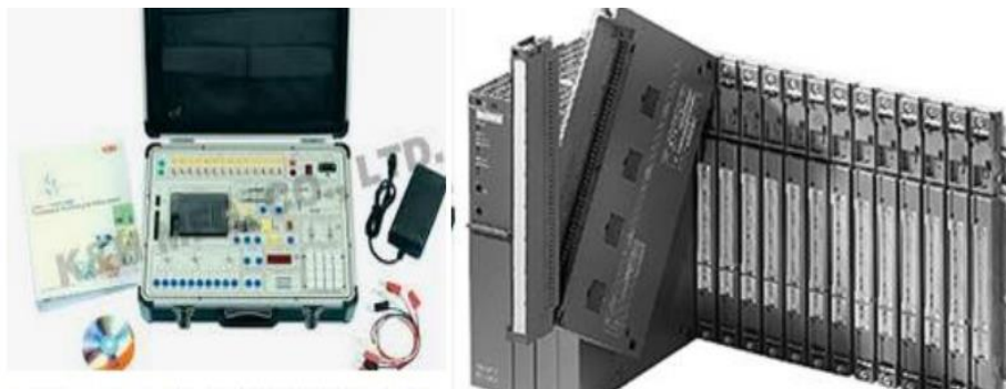
Figure II.5: Types d'automates : compacts et modulaires.
