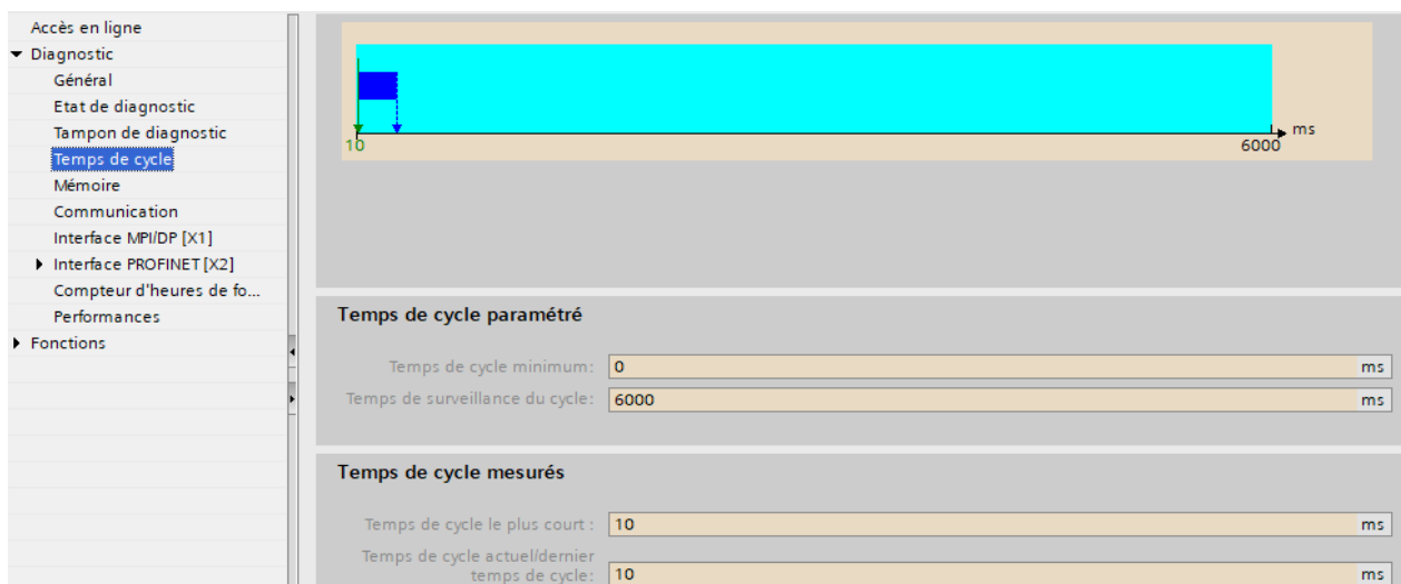
Figure 48. 1 : Temps de cycle paramétré.
