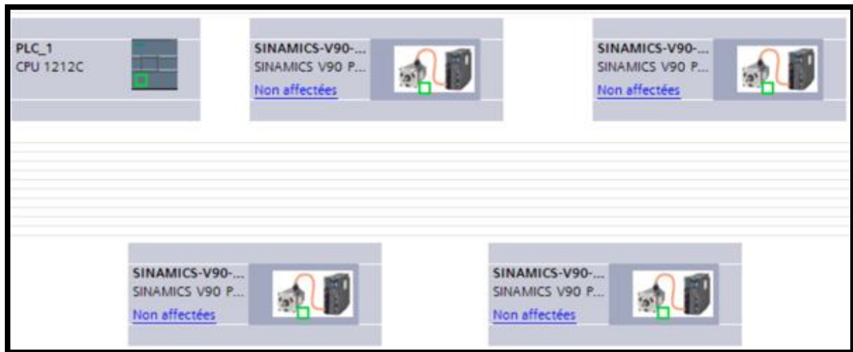
Figure IV.10–Insertion des variateurs dans la vue réseau
