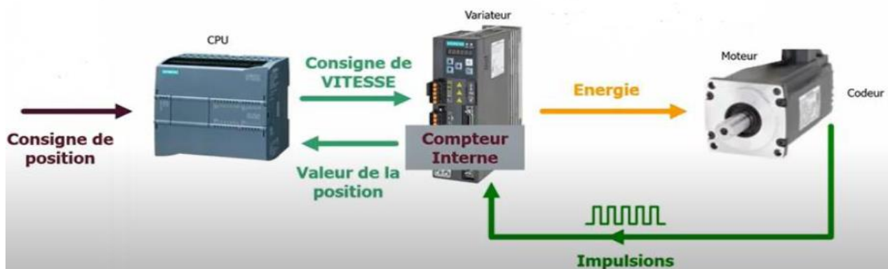
Figure IV.3– Boucle de régulation du système robotisé
