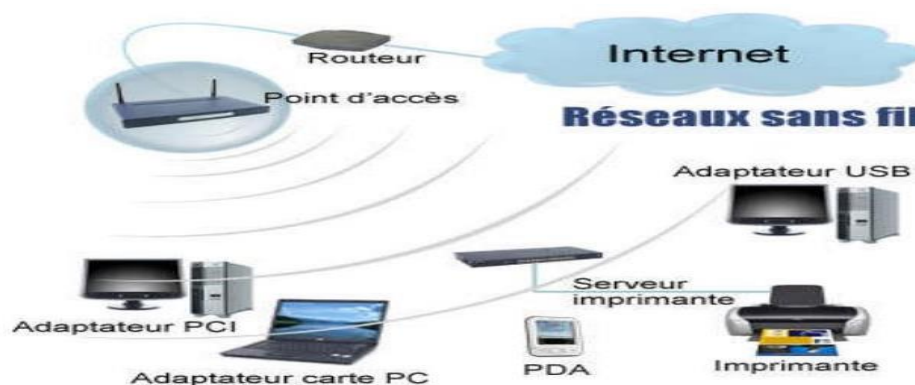
Figure 1 : Composition d'un réseau wifi [16, p. 8].
