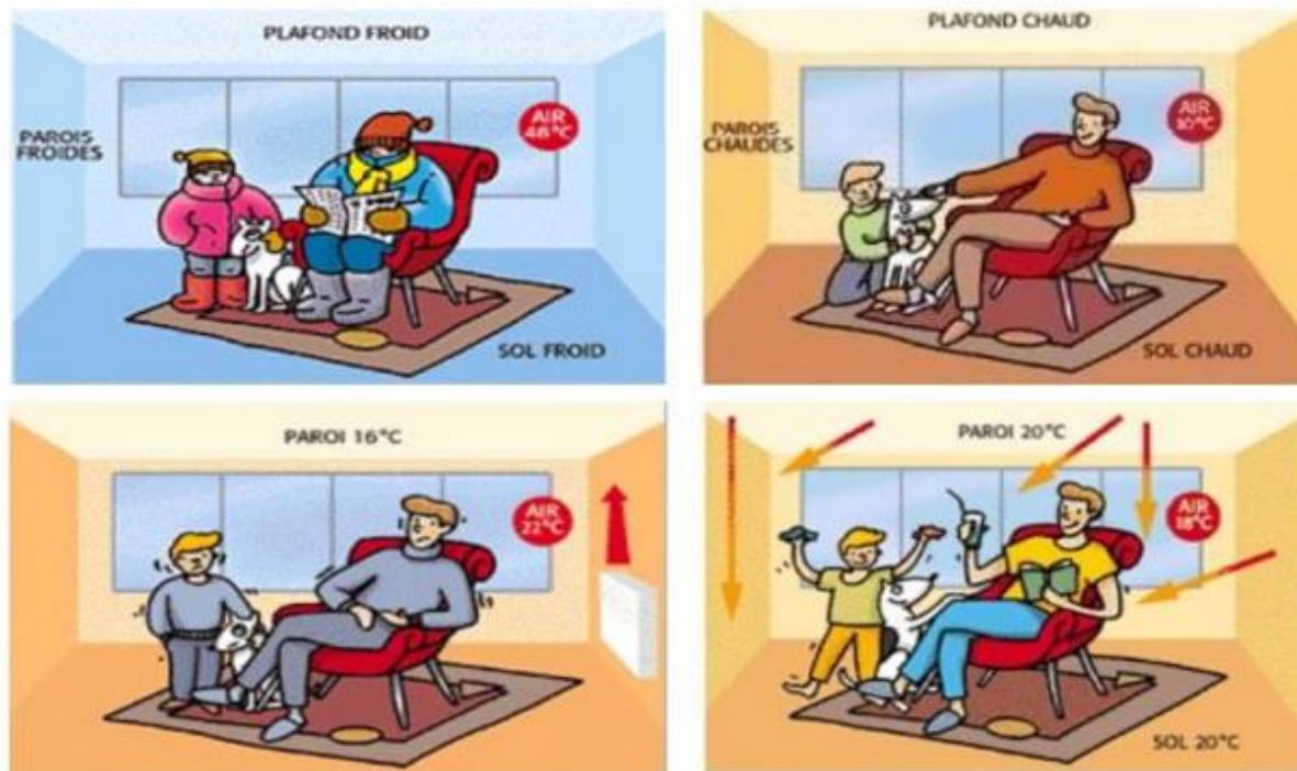
Figure 4: Experience sur l'importance de la température d'une paroi
