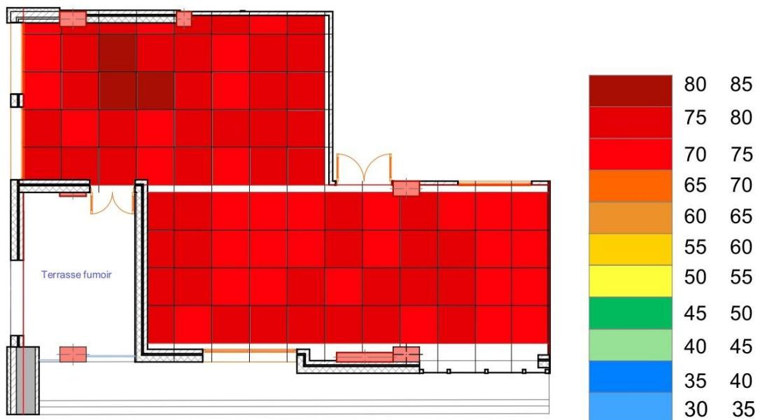
**Figure 71:** Résultat de prise de mesure dans la salle de lecture du R+2 bruit intérieur
