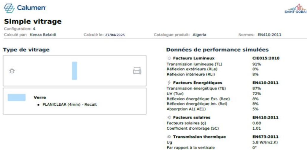
Figure 3.10: Composition du vitrage de la salle de lecture de la Maison de la Culture (Source : Calumen, adapté par l'auteur, 2025)
