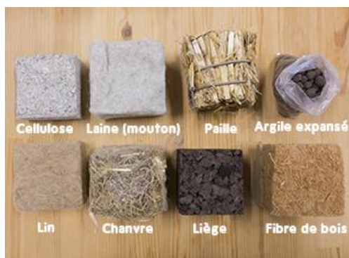
Figure 1.16 : Classification des isolants thermiques (Source : https://www.ecoconso.be/fr/content/6-isolants-ecologiques-sous-la-loupe )
