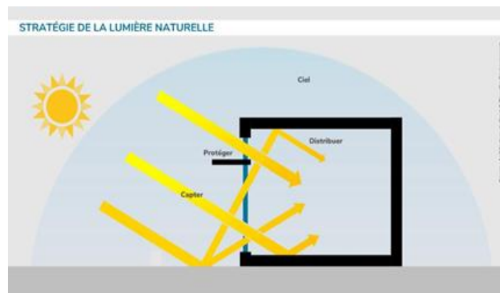
Figure 1.12 : Rôle de la surface vitrée dans l'apport de lumière
