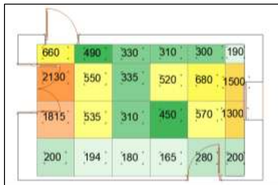
Figure 86 : Résultats de prises de mesures de la lumière in-situ : source : Auteur, 2025
