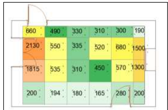
Figure 105: Résultats de prises de mesures de lumière in-situ/Source : auteur,2025
