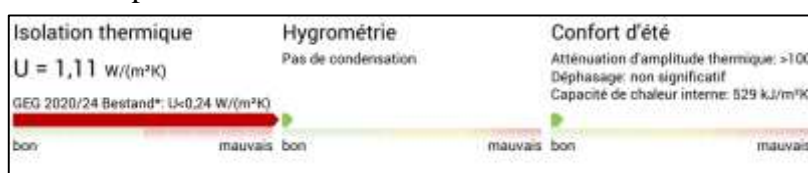
Figure 94: Isolation thermique du mur extérieur en pierre/Source : Auteur,2025
