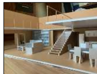
Figure 51 : Méthode expérimentale avec modèles à échelle réduite/Source : Daiche,2023
