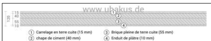
Figure 99: Composition du plancher à voutains/Source : Auteur,2025
