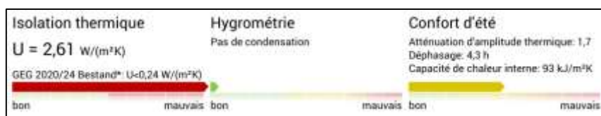
Figure 100: Isolation du plancher à voutains/Source : Auteur,2025
