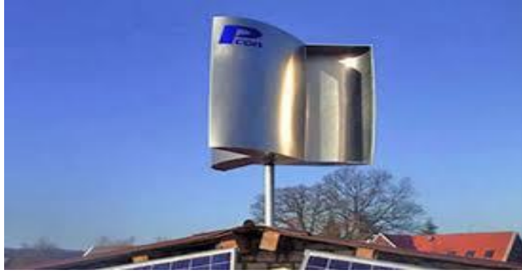
Figure I.6: Modèle d'éolienne Savonius auto-construite pour petite production d'énergie
