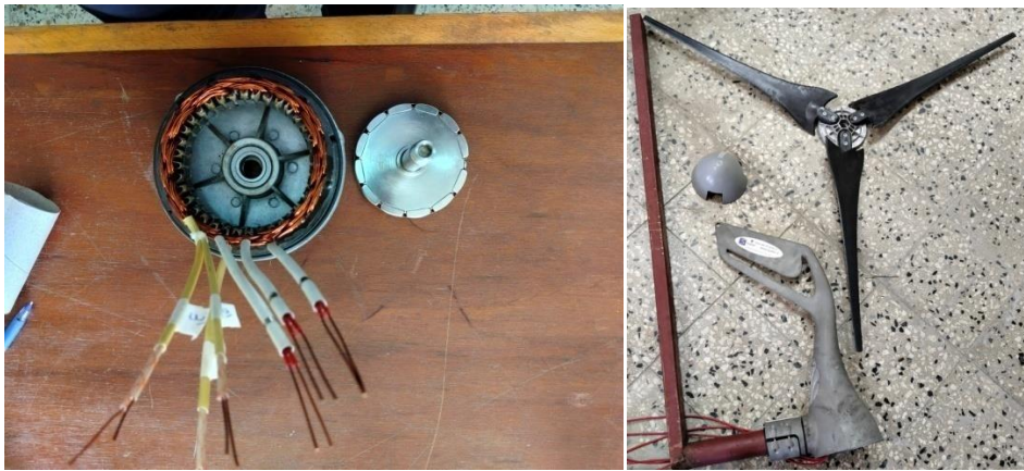
Figure III.6 : Différentes parties de l'éolienne étudiée à axe horizontal
